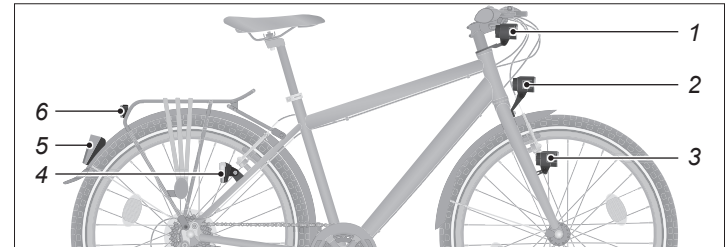
Abb.: Montageorte der Beleuchtungsausstattung
