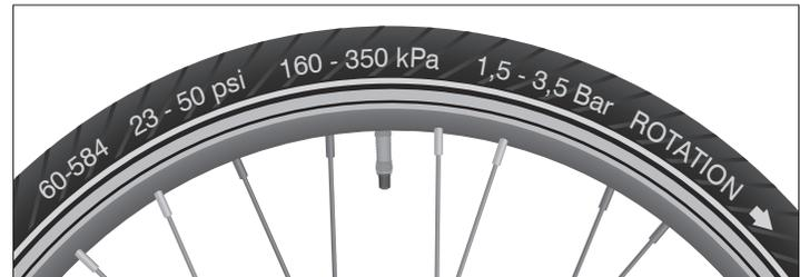
Abb. Aufdruck auf der Reifenflanke (exemplarisch)
